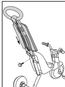
7. Inserire il manubrio nel tubo e fissarlo con la vite. Registrare l'altezza del manubrio: svitare la vite, muoverlo verso l'alto o il basso fino a quando non si trova la posizione desiderata, poi avvitarlo.
