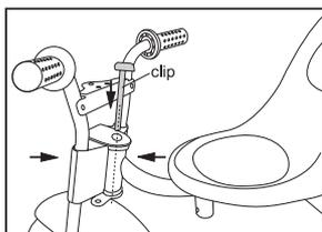
3. Inserire la parte anteriore del telaio nell'alloggio corrispondente alla forcella. Bloccare con il perno spingendolo fino in fondo.
