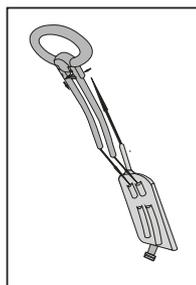
5. Premere la cintura della borsa attraverso l'asta della maniglia, inserire i due tubi del manubrio nei fori nel retro della borsa.
