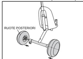
2. Inserire l'assale delle ruote posteriori nel tubo di collegamento poi inserire l'assale nel foro delle ruote.
