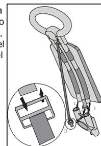
6. Inserire i due tubi del manubrio nei due fori del connettore di plastica, mettere la fibbia attraverso il connettore di plastica. Per finire inserire la cintura attraverso la fibbia.
